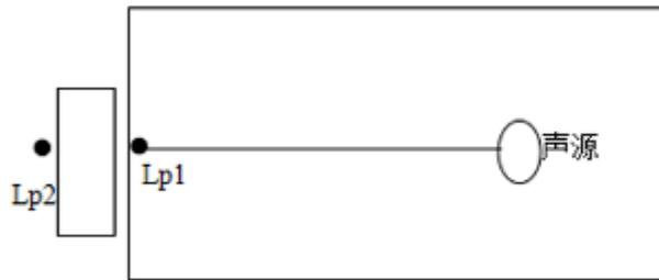
图 4-3 室内声源等效为室外声源图例
